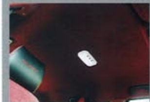
ワインレッドのアルカンターラで張り替えされた天井。鮮やかな光を放つルームランプはLEDに変更。
