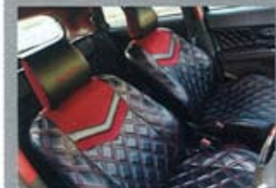
レザーとアルカンターラを組み合わせたシートの張り替え。ヘッドレストにはショップ名が刺繍される。
