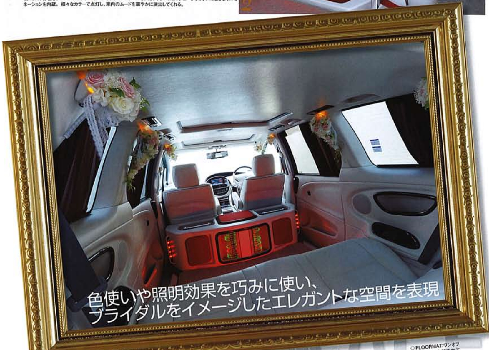
1フロントシート後部に作り込まれたボックス。アルパイン製のアンプやスピーカーがインストールされ、サラウンド空間をプロデュース。2後部座席下のキャビネットには、レッドの照明がエレガントなLEDイルミネーションが収められ、フットステップ部をほかに彩る。3クルマのオーナーがハンドメイドしたブーケを各ビラーに設置。間接照明により、存在をクローズアップ。4オーディオがインストールされたボックスには、ジュークボックスのようなイルミネーションを内蔵。様々なカラーで点灯し、車内のムードを華やかに演出してくれる。
